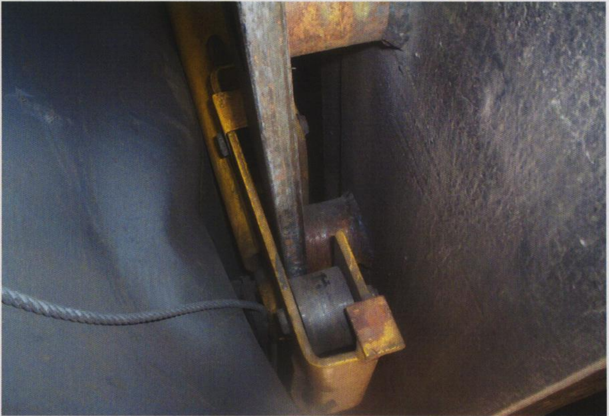
BRANDA ETEK KISMININ YÜRÜME MEKANİZMASINA BAĞLANTISI
